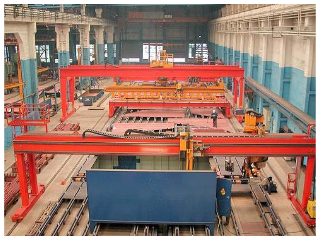
Bild 1: Im Vordergrund: mit Hybridschweißtechnik nachgerüstetes Schweißportal auf der Warnow Werft in Rostock-Warnemünde mit Sicherheitscontainer für Testschweißungen
