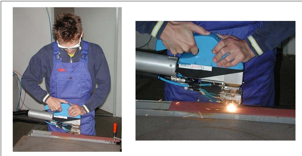
Bild 7: Arbeit mit handgeführtem Laserschweißkopf an der SLV M-V
