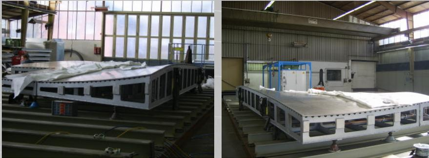
Dreidimensional verlaufende Schweißnaht mit ca. 7m Länge
