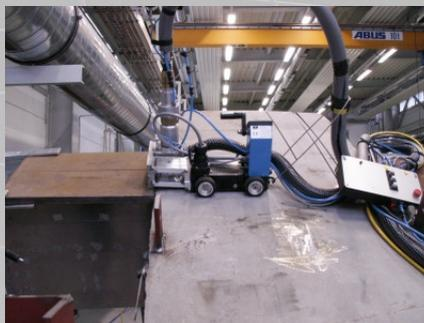
Schneidtests in vertikal fallender und in PB Position
