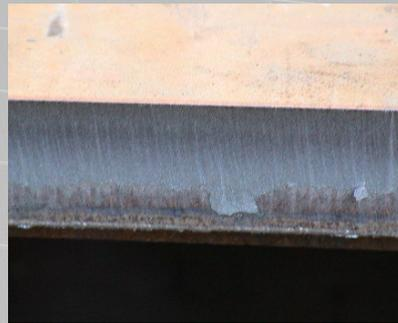
C-Stahl, Blechdicke 30 mm, Schneidgeschwindigkeit 0,5...1,0 m/min
