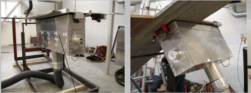
Strahlfänger unterhalb des Segmentes mit Absaugsystem in verschiedenen Positionen
