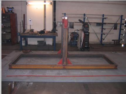
Vorrichtung zum Drehen des Kugelsegmentes für die Einstellung unterschiedlicher Schneidpositionen
