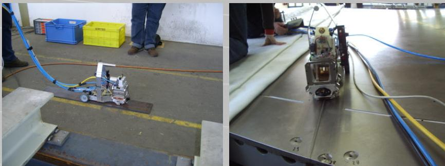
Traktor mit Laserschweißkopf
